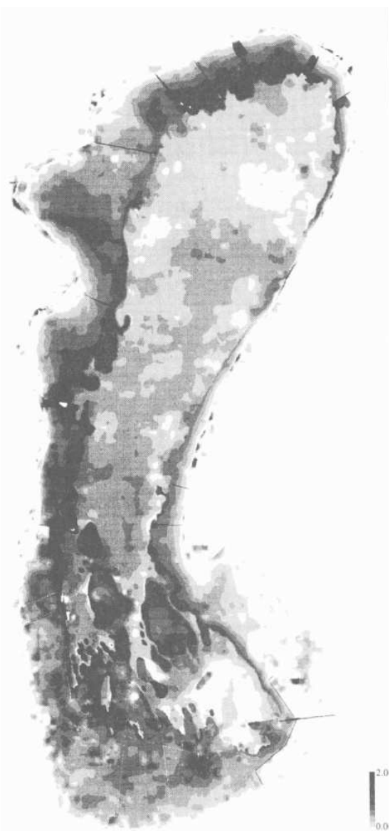
Abb. 13. Karte der Sedimentablagerungen im Seebecken in Stufen von \Delta h = 20\text{cm} (Csaplovics et al. 1997).
